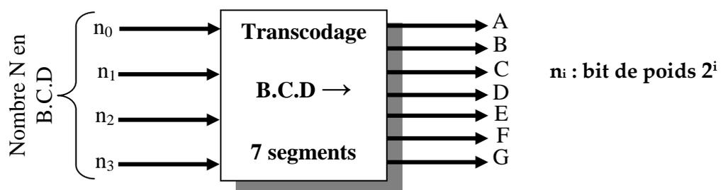
On donne, sur la **figure 11** ci-dessous, le repérage des sept segments de l'afficheur, et on convient d'associer la valeur 1 au segment qui doit être allumé, et la valeur 0 à celui qui devra être éteint.
