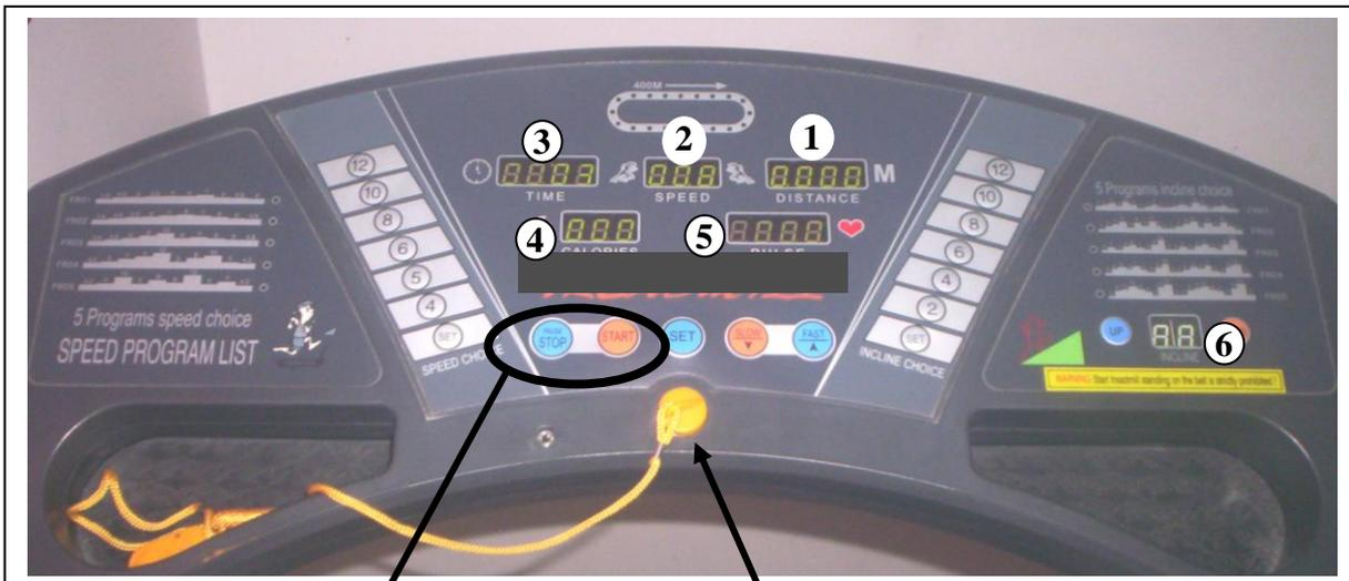
**Boutons M/A : mise en marche et arrêt de l'appareil**
