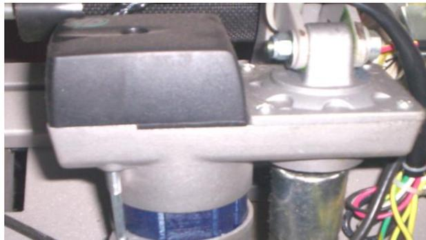
**Photo 11 : actionneur d'inclinaison du support**
